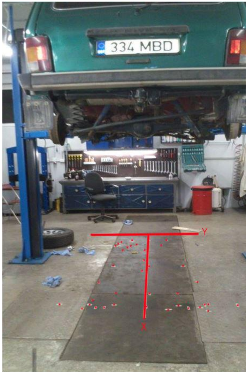
Joonis 2. Tagavedrustuse punktide projekteerimine ekraanile (põrandale) ja koordinaatteljestik [7]
