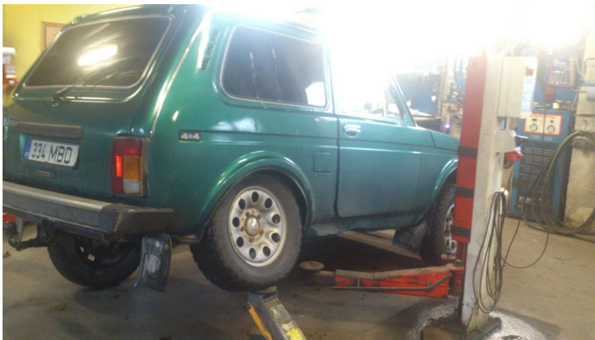
Joonis 4. Niva maksimaalse vedrustuspiiri mõõtmine [7]
