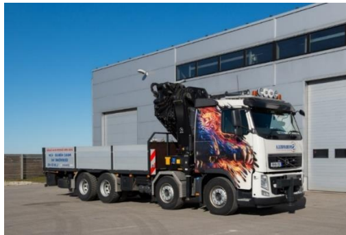
Joonis 2. Tõstukauto Volvo FH12 8x4 hüdrotõstukiga [15]
