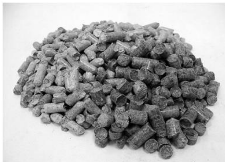
Joonis 4. Puitgraanulid ehk puitpelletid - kuivatatud ja peenestatud puidujäätmest pressitud peened (sõrmejämmed) pulgad või kuubid [17]
