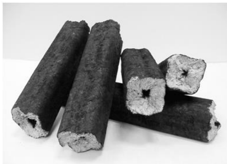
Joonis 3. Puitbrikett - peenestatud ja kuivatatud tootmisjäätmest valmistatud kõrge rõhu all. [17]
