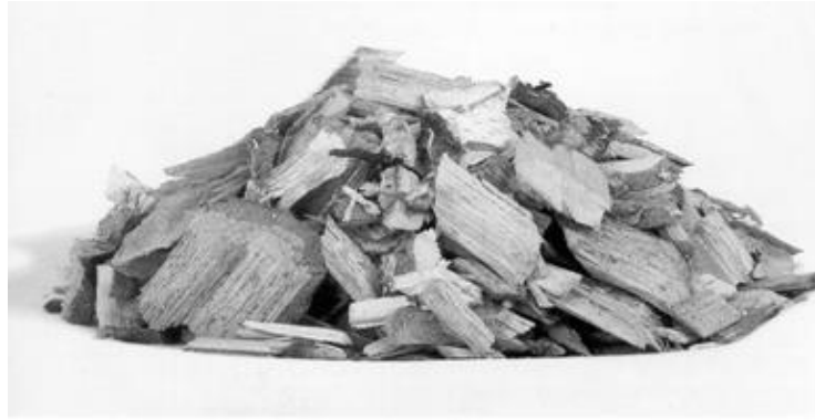
Joonis 2. Hakkpuit - spetsiaalse hakkuriga sobimatutest tüvedest, laasitud tüvedest, raie- või puidutöötlemisjäätmest peenestatud kütteaine (keskmine suurus 25...40 mm) [17]
