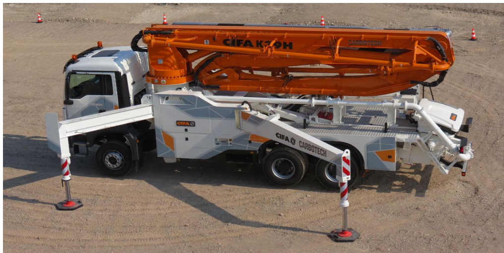
Foto 3. 35 m. mastiga betoonipump [33]
