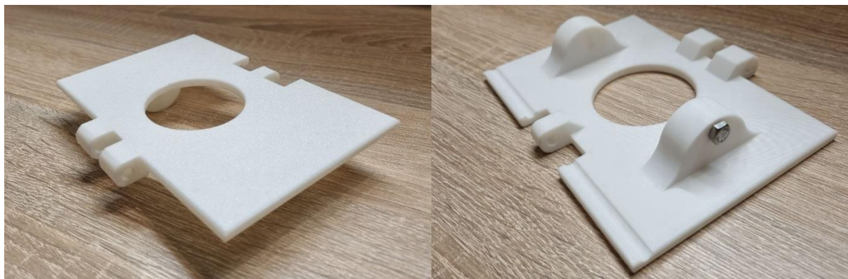
Joonis 20. Esimese konveieri 3D-printeriga trükitud segment.
