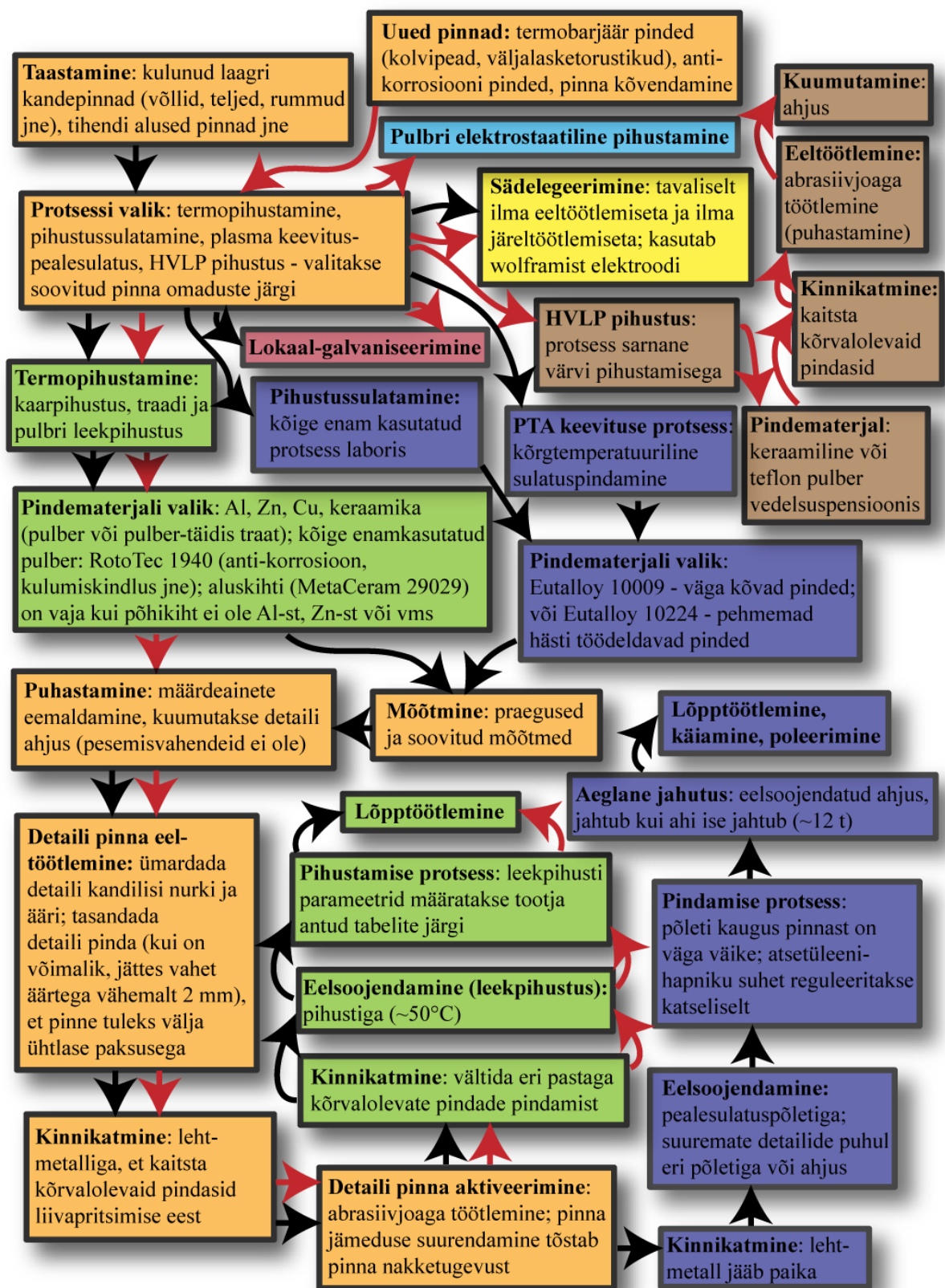
Joonis 3.1. Pindamise protsessid, mida käesoleval hetkel viiakse läbi pindamistehnoloogia laboratooriumis.
