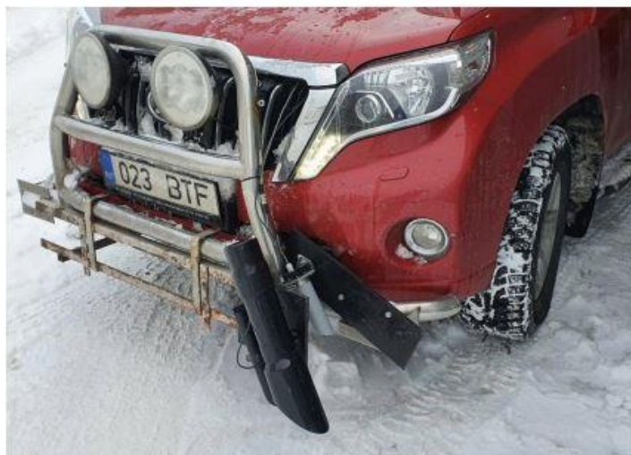
Foto 1. Optiline haardetegurimõõtur suunatuna vasakusse rattajälge [7]
