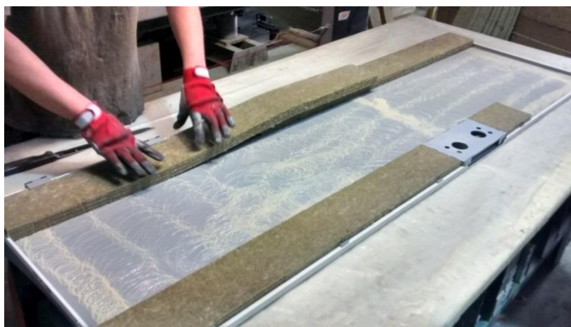
Sele 12. Villa paigaldamine ukselehte
