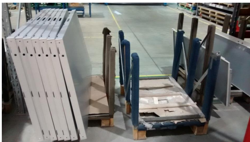
Sele 10. Painutatud ukselehe pooled pooltoodangu alusel.
