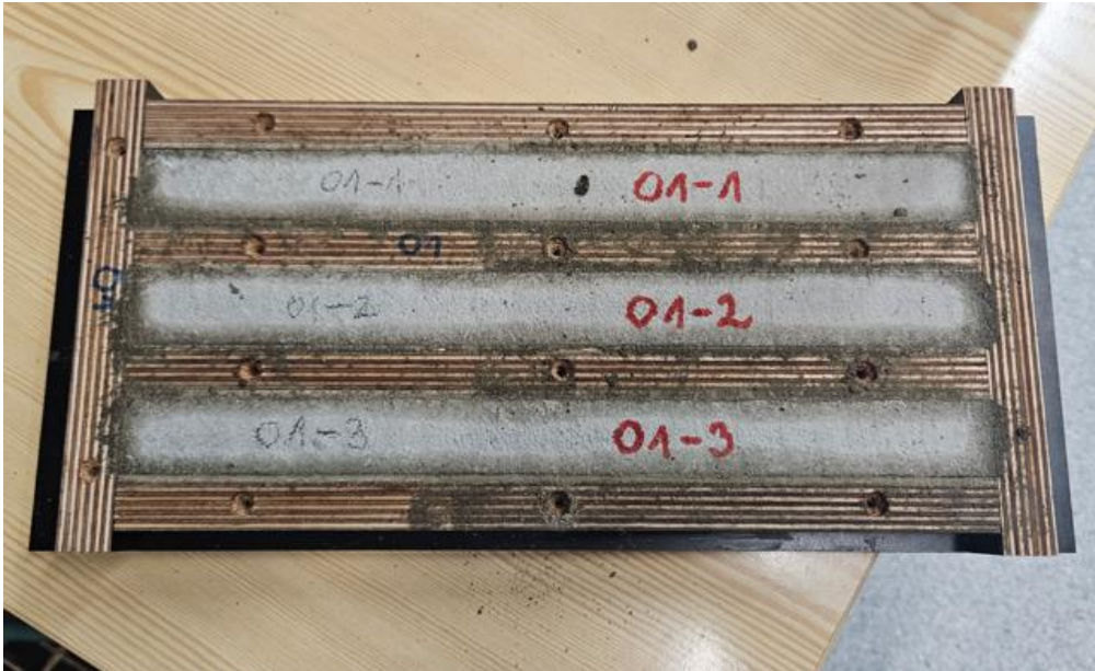
Foto 13. 25×25×285 mm mördipulgad enne vormist eemaldamist
