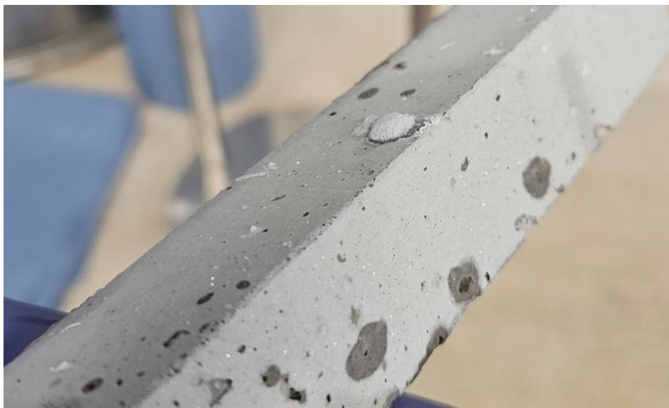
Foto 30. Eritis Krüüdneri karjääri liivast valmistatud mördipulga pinnal
