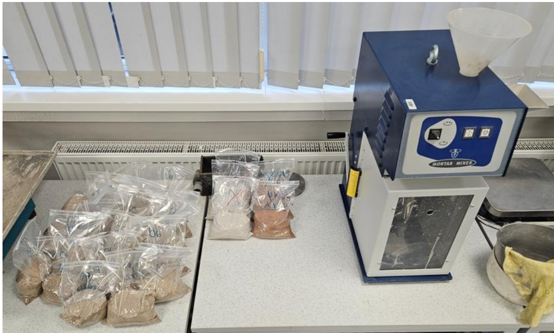
Foto 24. Mõrdi valmistamiseks kasutatud mikser koos valmis kaalutud liivadega
