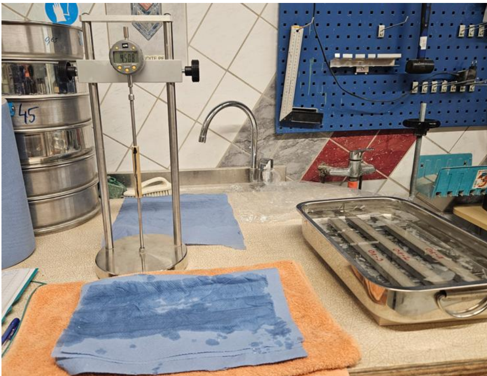
Foto 14. Mördipulgad veevannis ja laboratoorne võrdlusmõõteseade ( length comparator )
