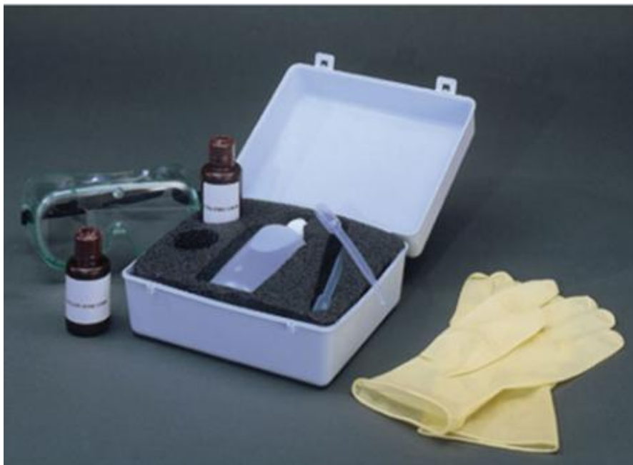
Foto 4. Indikaatorvedelikega testkomplekt ASR-i tuvastamiseks [37]
