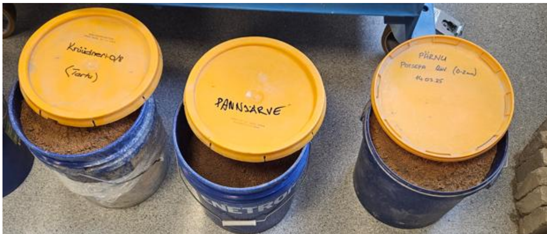
Foto 17. Krüüdneri, Pannjärve ja Pottsepa karjääridest pärinevate liivade näidised Tallinna Tehnikakõrgkooli laboris
