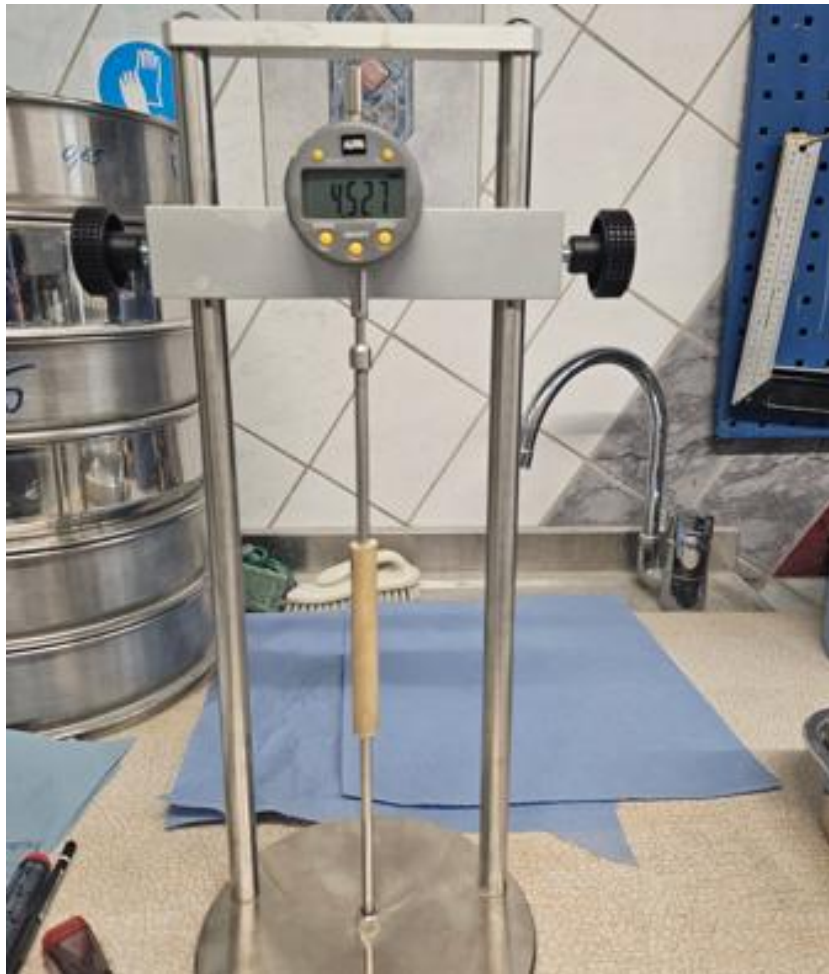
Foto 26. Referentsväärtuse mõõtmine referentspulga abil [51]
