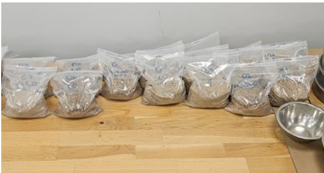
Foto 21. Mördi valmistamiseks välja kaalutud ja pakendatud liiv
