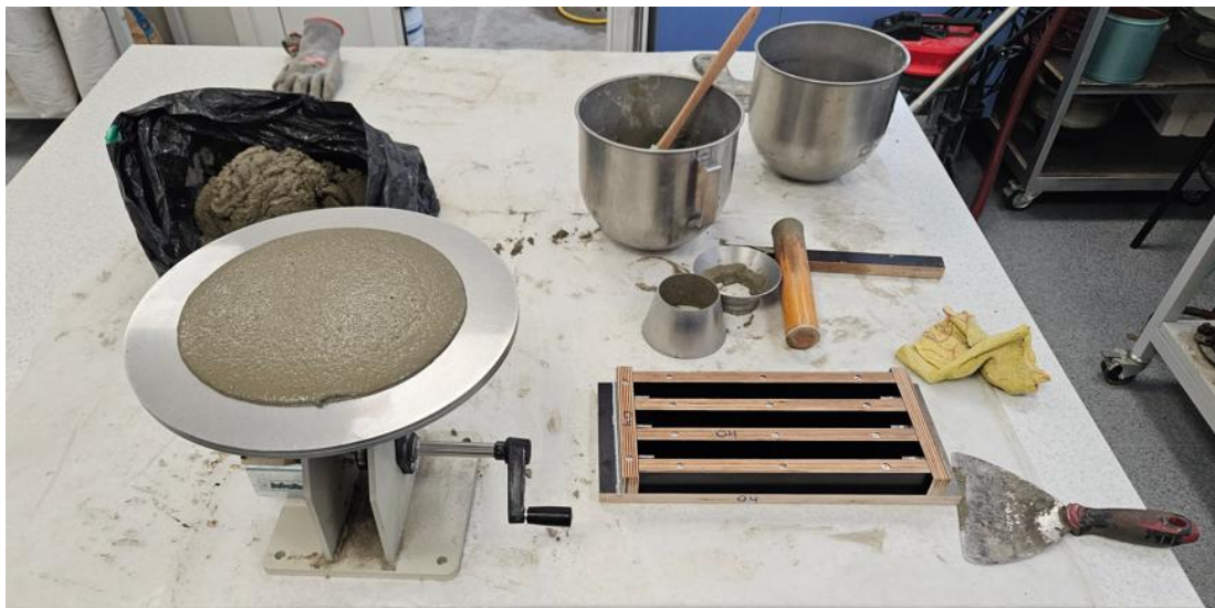
Foto 23. Segu valgumist mõõdeti valgumislaual – nõuetekohase valgumise korral paigutati mört edasi vormidesse ja tihendati vastavalt kahes osas
