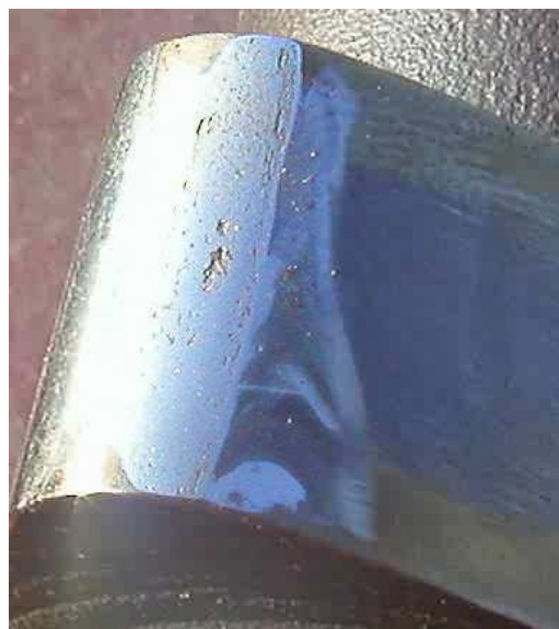
Joonis 34. Mootori nukkvõlli nukatipu pindväsimumus (pitting)
