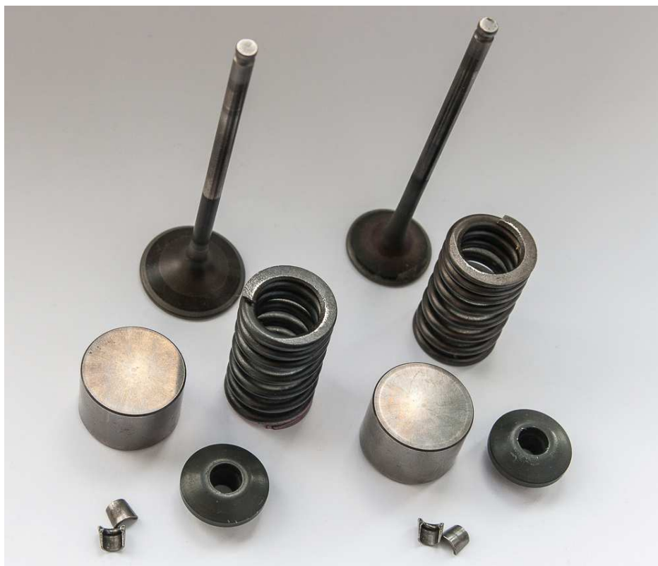
Joonis 29. Klapimehhanismi komponendid [11]
