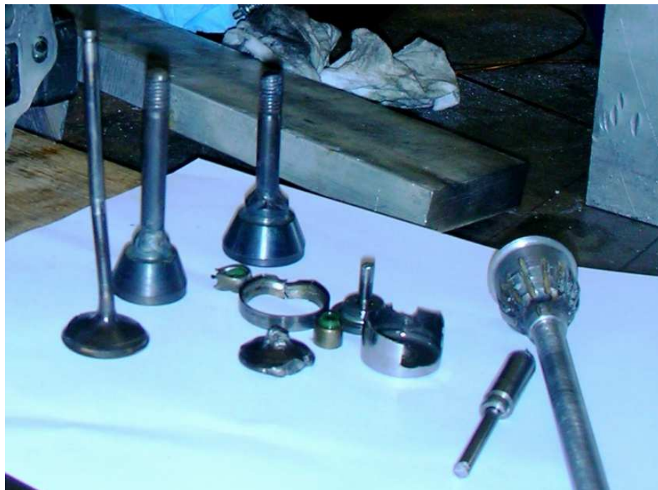
Lisa 7. FEST10 mootori purunenud klappimehhanismi detailid ja kahjustatud plokikaas
