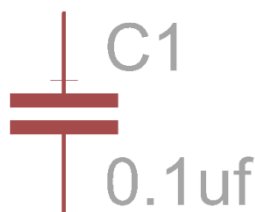
Joonis 2. Üks võimalik kondensaatori sümbol Eagle CAD pakettis
