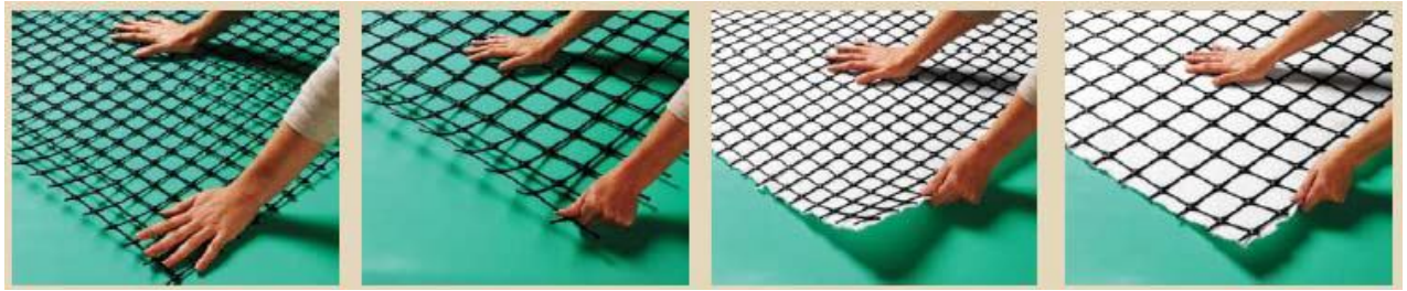
Joonis 15. Geovõrk ja geokomposiit (võrk + tekstiil) [17: 16]
