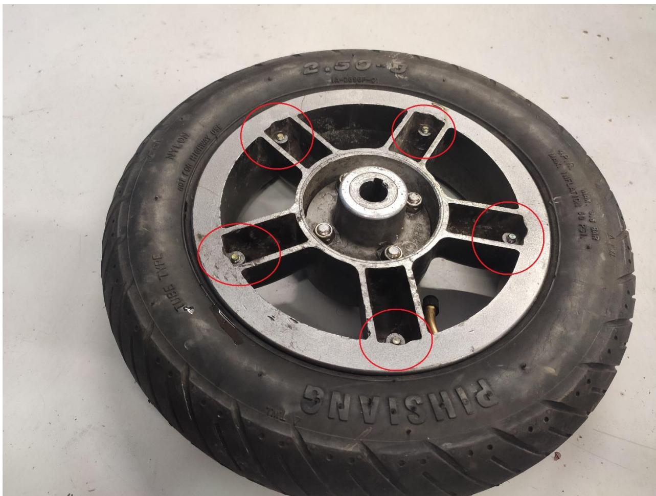
Sele 14. Alternatiivne piduriketta kinnituskohd rattal
