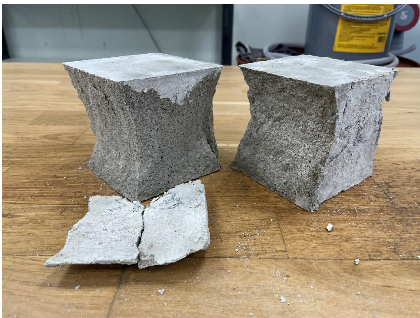
Foto 7. Purustatud katsekehad SK3 ja SK4
