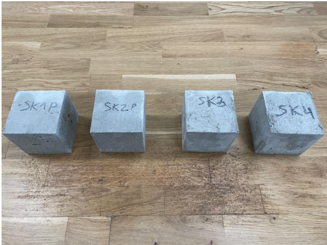
Foto 5. Betoonkuubikud purustusjõu ja survetugevuse määramiseks
