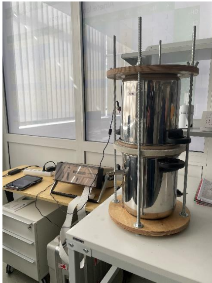
Foto 12. Difusioonikamber ja Radon Eye Plus2
