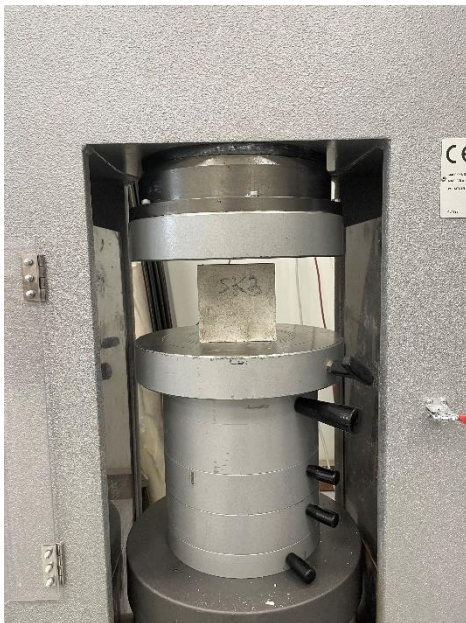
Foto 6. Katsekehad SK3 ja SK4 pressi all
