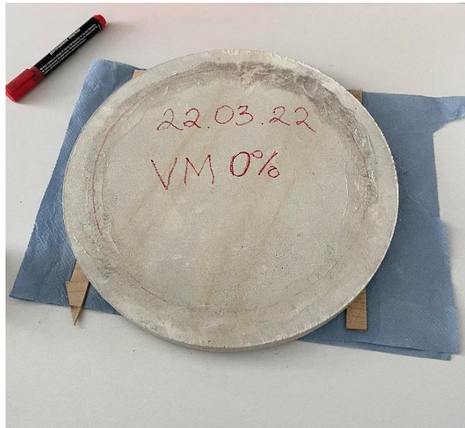
Foto 8. Tavalisest betoonist kettakujuline katsekeha KKTB
