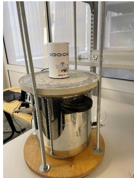
Foto 12. Difusioonikamber ja Radon Eye Plus2
