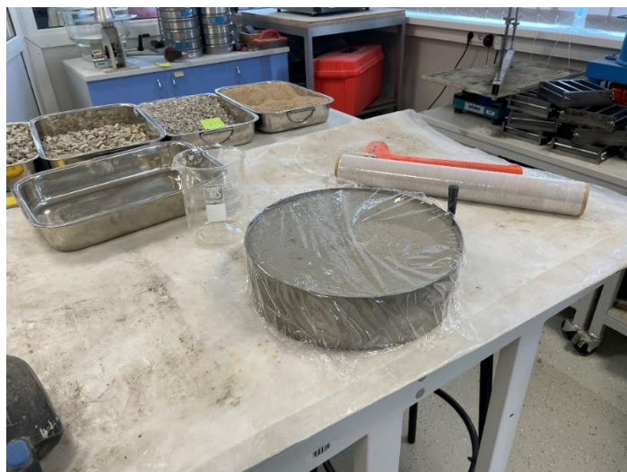
Foto 1. Kettakujuline proovikeha tavalise betooniga
