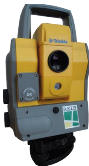
Foto 1. Trimble 5503 DR Total Station (Autori foto)
