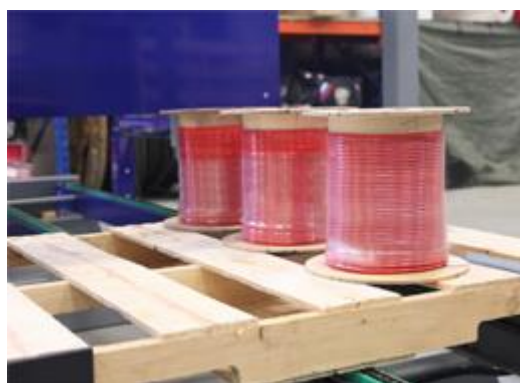
Joonis 4. Keritud kaabel puitpoolil. [5]
