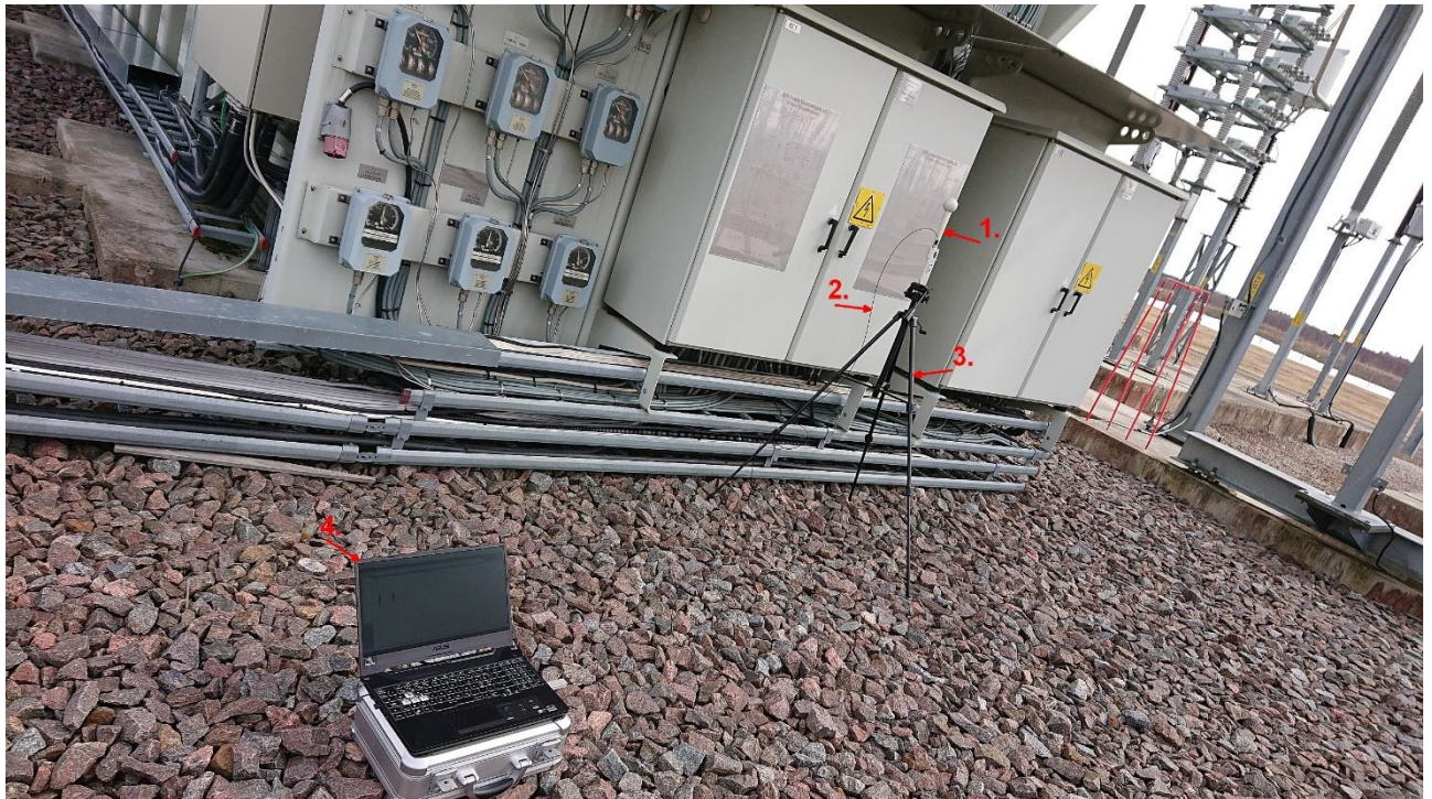
Joonis 8. Elektri- ja magnetväljade mõõtmine: 1– mõõteseade ESM-100, 2 – optiline kaabel, 3 – statiiv, 4 – arvuti mõõtmis tarkvaraga
