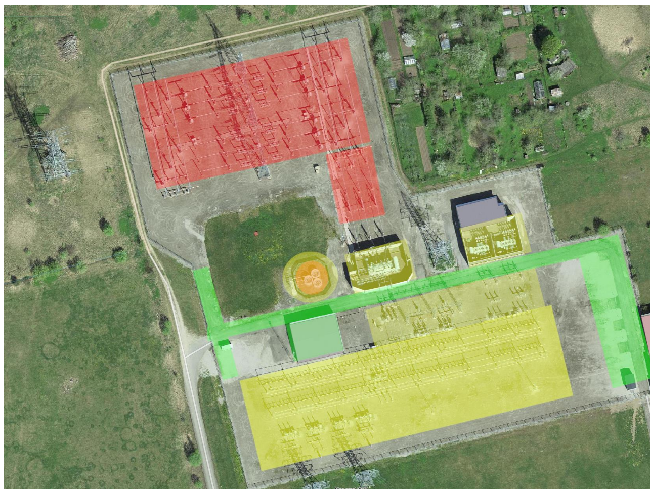
Joonis 17. Ohutusplaan Rakvere alajaama näitel. Punane – kõrgendatud ohuga ala; kollane – ohtlik ala; roheline – väheohtlik ala
