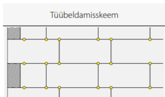
Joonis 10. Fassaadisoojustuse tüübeldamisskeem [19]
