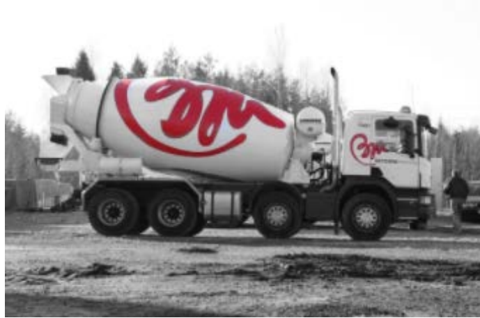
Joonis 5. Betoonimikser Liebherr HTM 904 [31]
