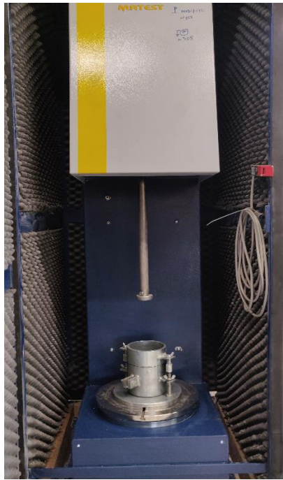
Foto 5. Katsekehade valmistamiseks kasutatav Proctor seade [Erakogu]
