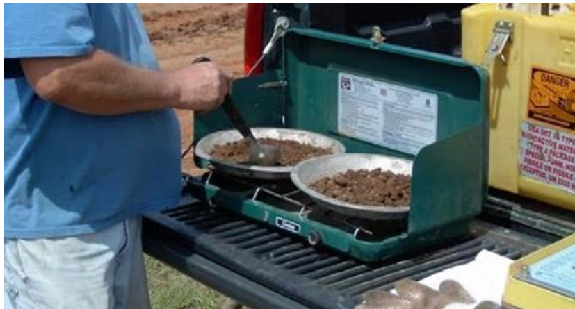
Foto 1. Pinnaseproovi kuumutamine veesisalduse välja selgitamiseks [8]
