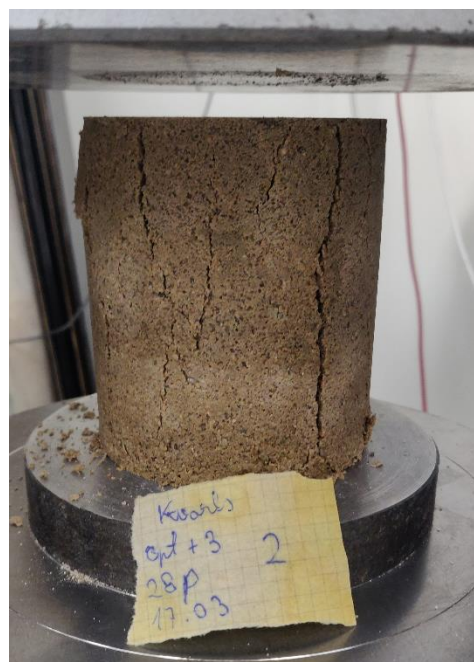
Foto 7. Kvartsliidast katsekeha purunemismuster [Erakogu]
