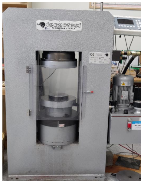
Foto 6. Katsekehade survetugevuse mõõtmiseks kasutatav press [Erakogu]
