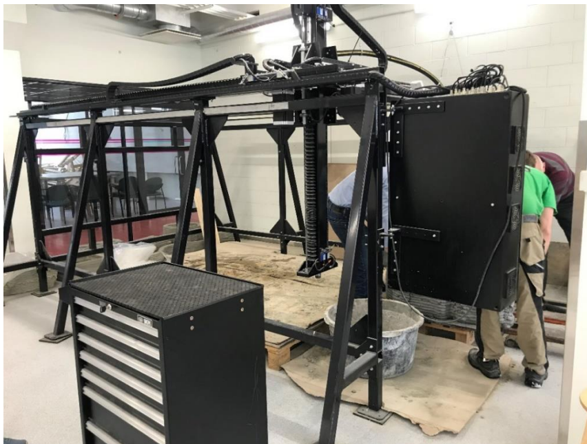
Joonis 3. Sildprinter Tallinna Tehnikakõrgkoolis [autori foto]
