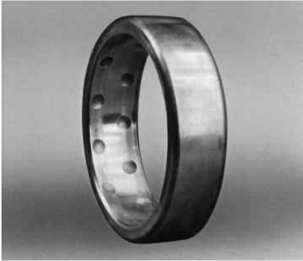
Pilt 3. Kuullaagri kahjustunud välisvõru [11]
