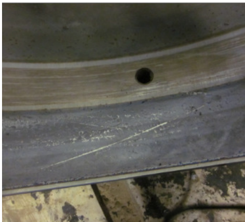
Pilt 5. Kriimustusjäljed veereteedel
