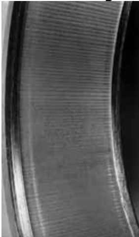
Pilt 2. Koonusrullaagri kahjustunud välisvõru [11]
