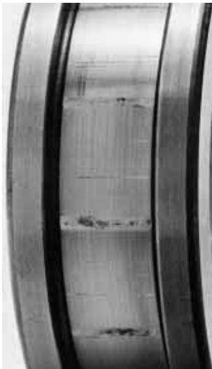
Pilt 1. Silinderrullaagri kahjustunud välisvõru [11]
