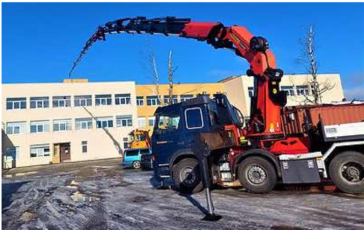
Joonis 3. Kraanaauto Volvo hüdrokraanaga Palfinger PK100002 [7]
