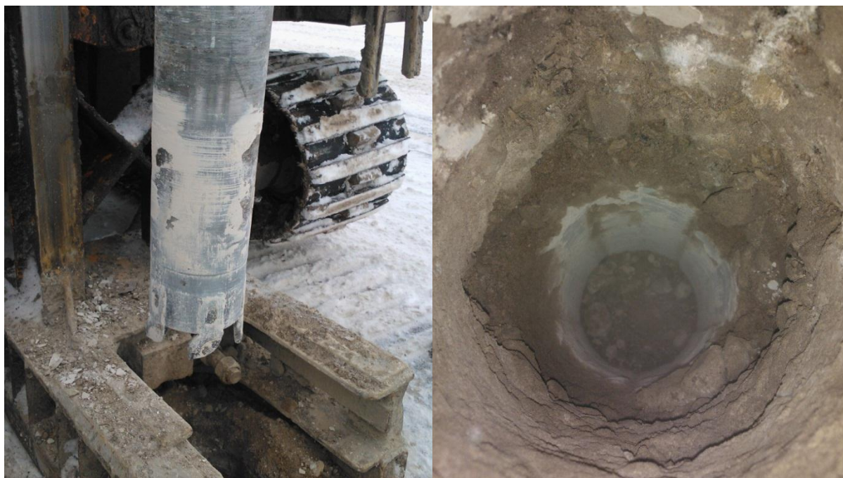
Foto 13 ja 14. Tolmune/savine mulde materjal on puurpea külge kinni kinninud. Katendi ehitamisel kasutatud killustik ja liiv on võrreldes muldes kasutatud materjalidega oluliselt kohevamad. [26: 5]
