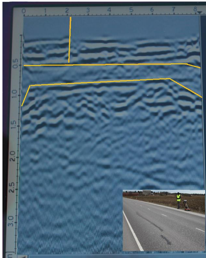
Joonis 7. Foto 12 kujutatud defekti maaradari pilt. Vertikaaljoon on praao asukoht ja horisontaaljooned näitavad mulde materjali. [26: 19]
