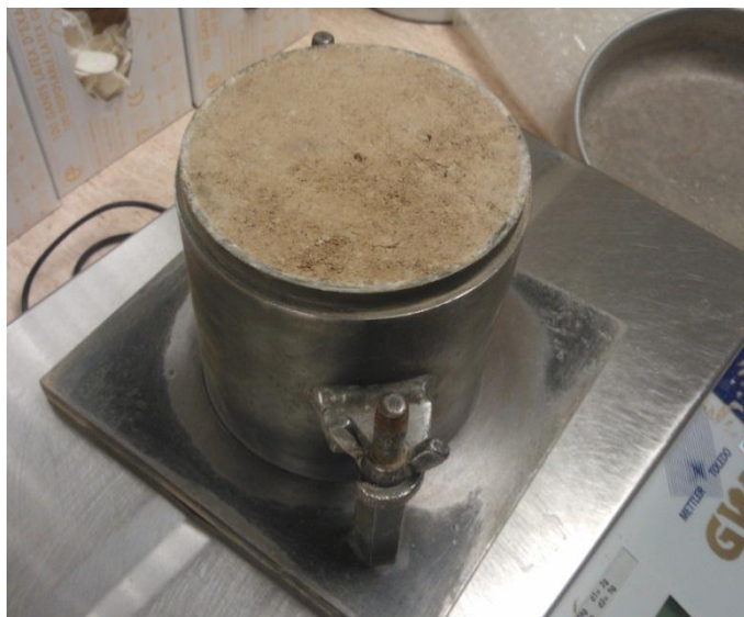
Foto 15. Muldes kasutatud materjal pärast Proctor-katset. [26: 15]
