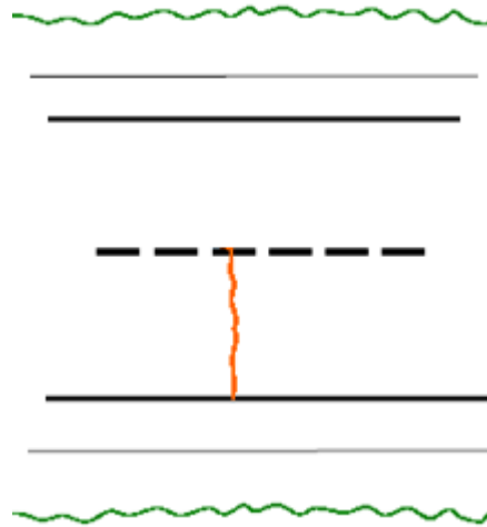
Joonis 4. Pragu kulgeb maantee põiksuunas ja on tekkinud teekatte paigaldamisel katete liitekohal pikkusega 3m – inventeeritakse vuugipraona 3m [15: 14]
