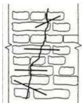
Pilt 20. Pragude ankurdamise põhimõtteline skeem [16].
