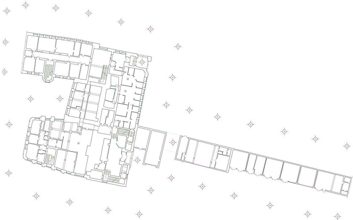
Joonis 9. Laserskanneri asukoha näide hoone väljast mõõtes. Kindelpunktid tähistavad asukohti
