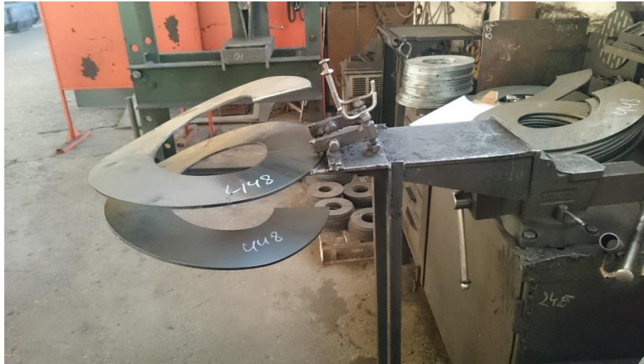
Sele 13. Kruvisektorite keevitamise rakis
