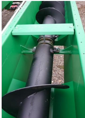
Sele 4. 14 meetrise filtrikruvikonveieri ühenduskoht vahepuksidega
