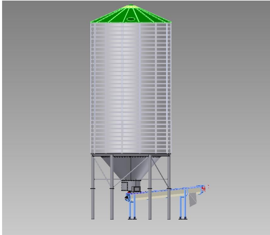
Sele 2. Hoidla 200m 3 koos väljalaadimisteoga 3D modelleerimises
