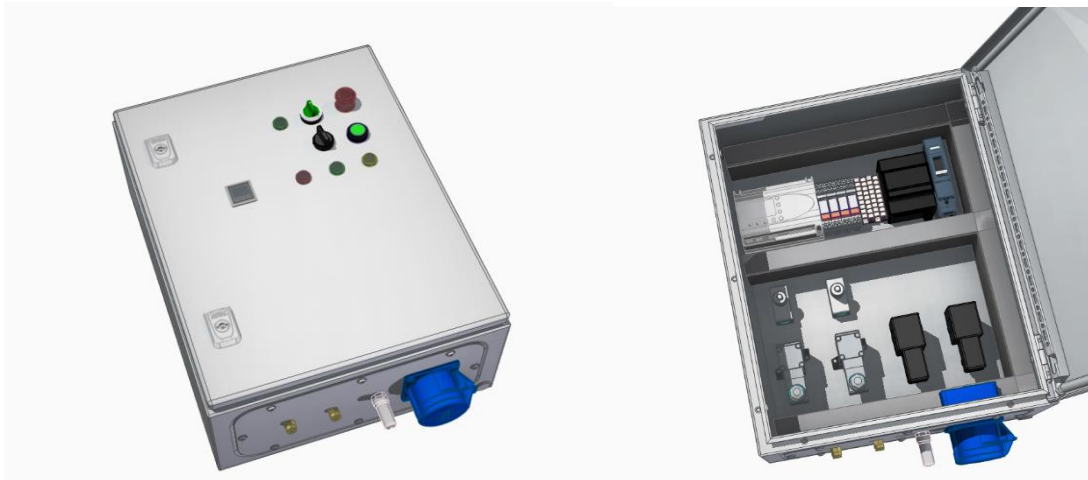
Joonis 15. Testseadme planeeritud disaini peegeldav CAD-mudel Solid Edge keskkonnas
