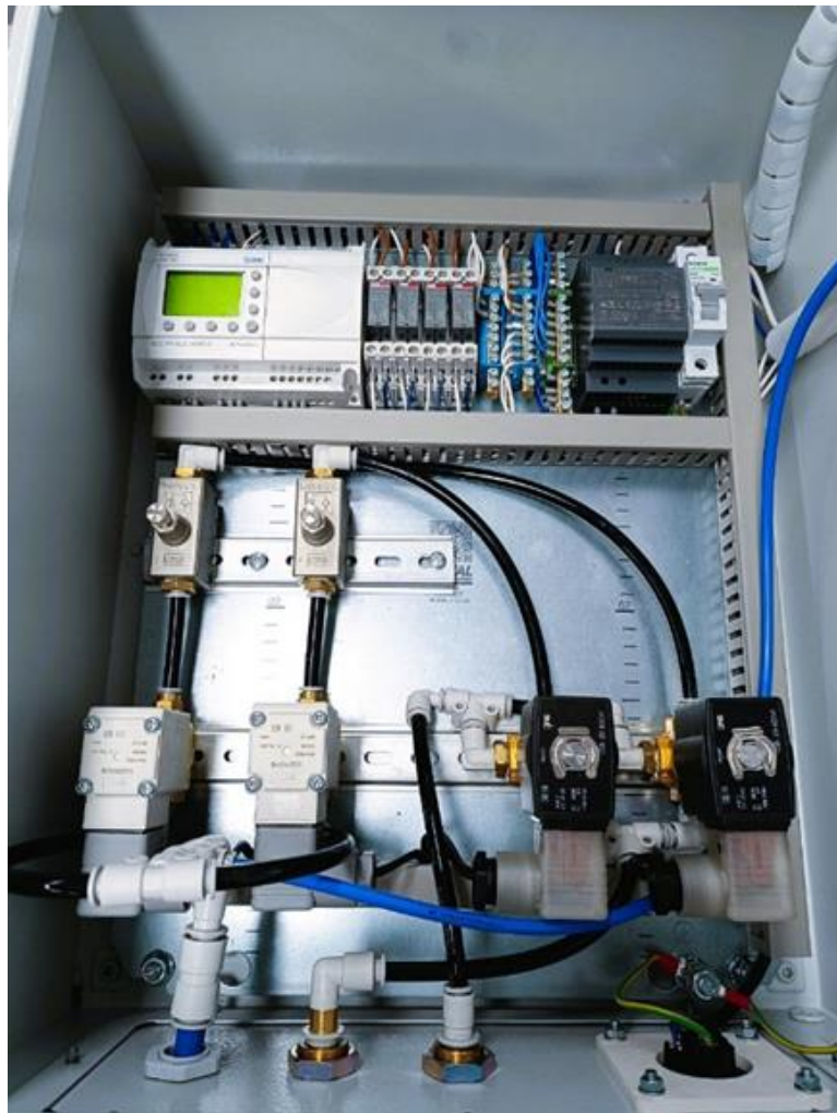
Joonis 18. Testseadme sisemus: elektrikomponendid, pneumaatika
