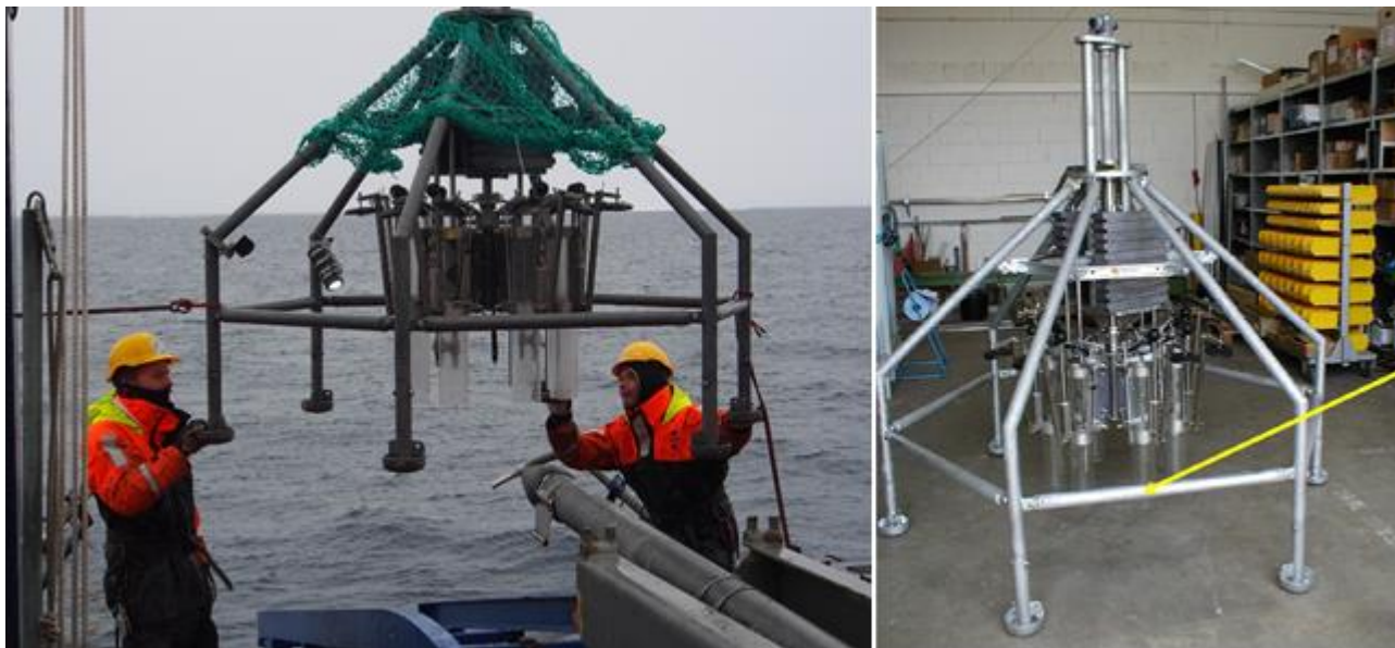
Sele 2. Üheaegselt mitme setteproovi võtmise seade [2], [4]
