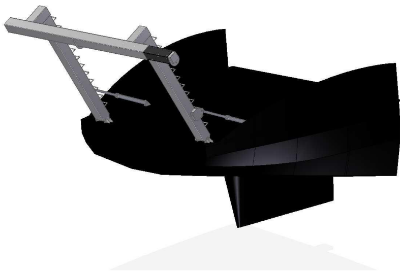
Sele 12. A-portaali paigutus ahtritekil
