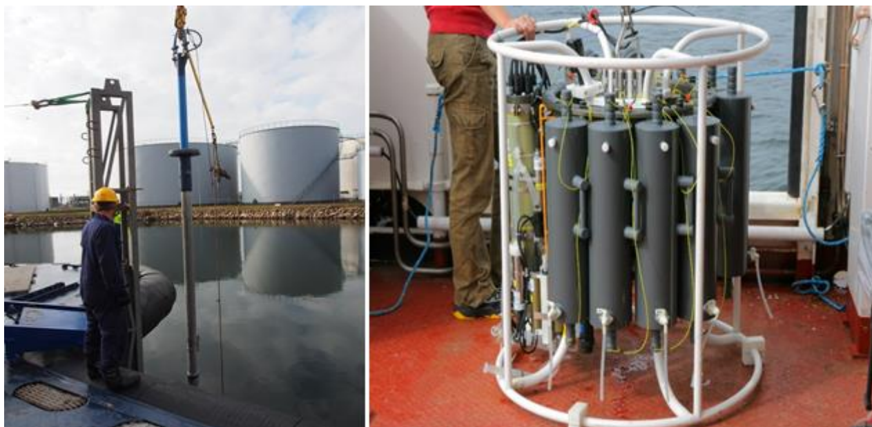
Sele 9. Setteproovide poomi tööasend (vasakul) ja mitme proovi võtmise seadeldis(paremal) [3]
