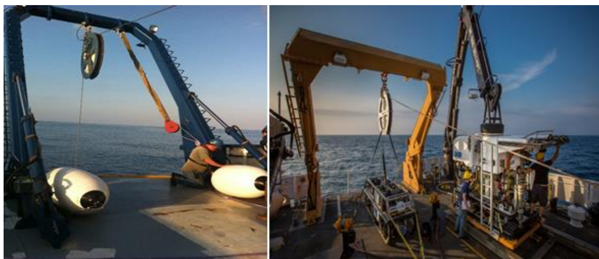
Sele 7. Erinevad portaalkraanade lahendused lihtsamate ja keerulisemate tööde jaoks laeval [8]
