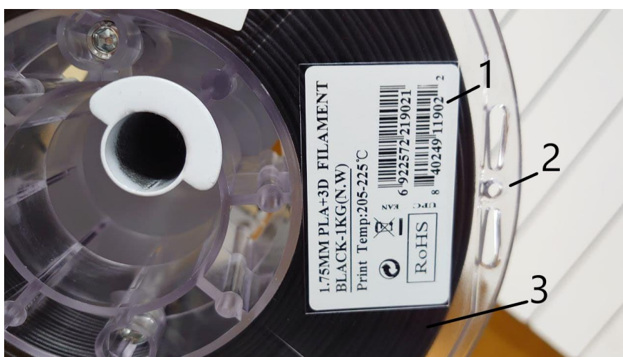
Joonis 25. eSUN PLA+ 1,75mm polülaktiidist valmistatud 3D-printimismaterjal, mida kasutati MakerBot Replicator printeriga
