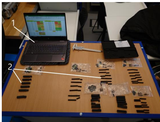
Joonis 6. Tõmbekatsetele järgnev purustatud katsekehade analüüs ja andmete sisetamine Microsoft Exceli programmi
