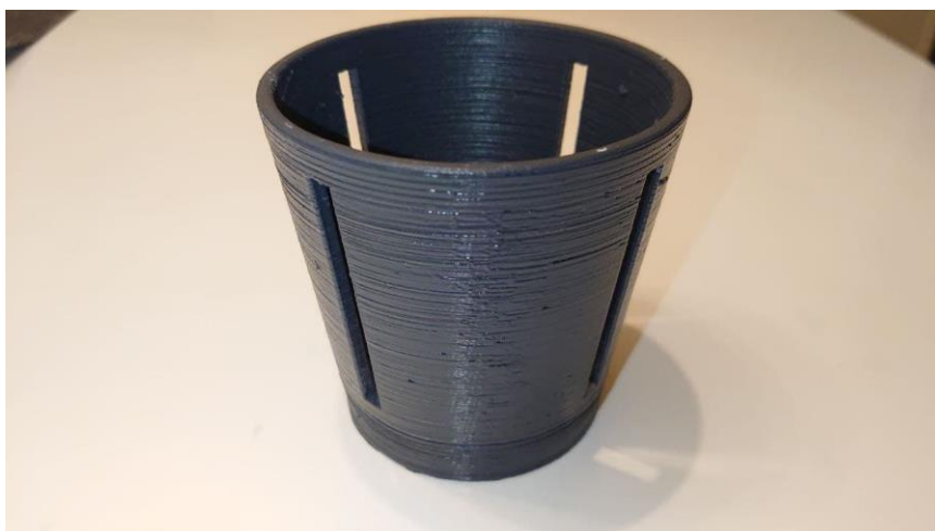
Joonis 23. Värvitud topsihodija pinnakvaliteet
