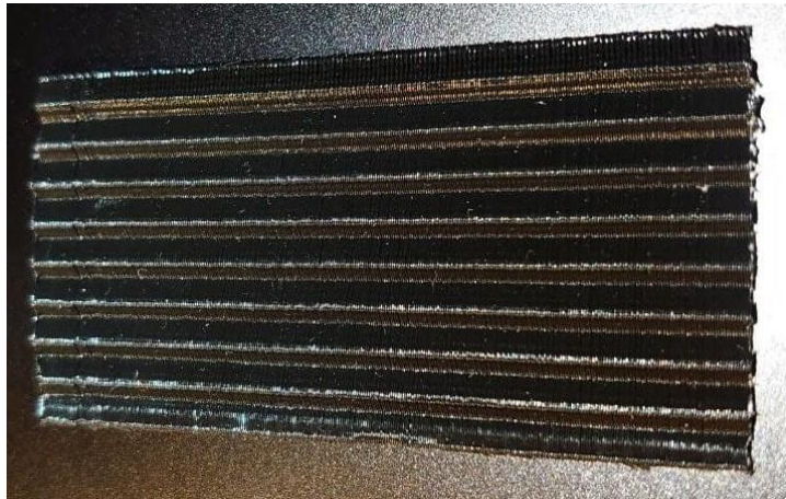
Joonis 26. Sarrustamiskarkass, millega on täidetud detailide õõnsused, et tugevdada kergemat konstruktsiooni
