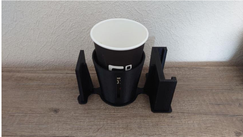
Joonis 27. 3D prinditud lõpptoode koos selle sisse asetatud joogitopsiga enne lõpliku viimistlust
