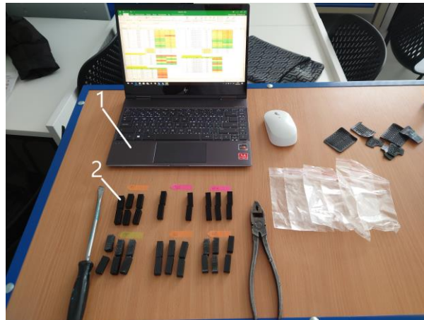
Joonis 8. Löögisitkuse katsetele järgnev purustatud katsekehade analüüs ja andmete sisestamine Microsoft Exceli programmi 1 – arvuti koos avatud Microsoft Exceli tarkvaraga, 2 – purustatud katsekehad
