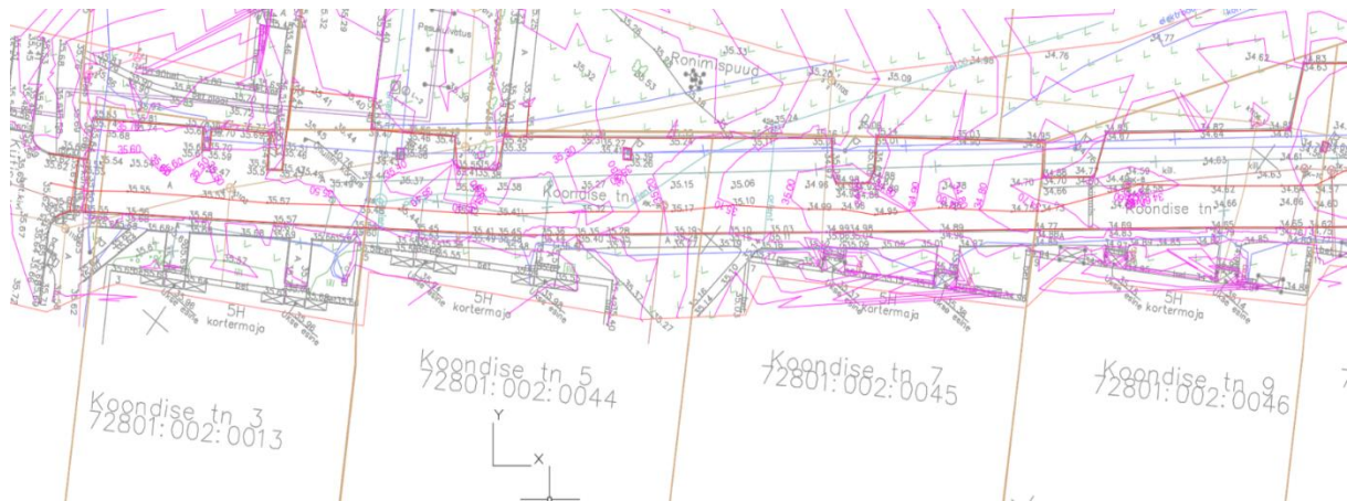
Joonis 9. Olemasoleva pinna maamudel, kus roosad jooned tähistavad kõrgusjoone astmega 10 cm
