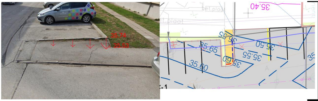
Joonis 5. Vasakul pool on kujutatud kergliiklustee osa järsud kalded koos kõrguspunktidega, paremal pool on kujutatud projekteeritud lahendus, kus on lisatud haljasala osa, millega parandatakse järsud kalded
