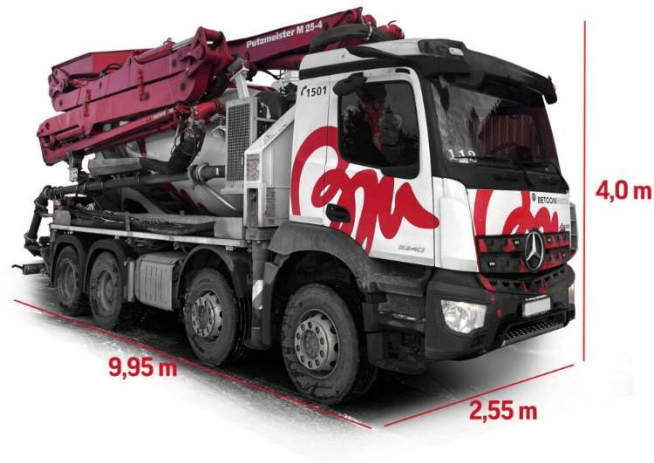
Joonis 7. Betoonimikser ehk pumi [20]
