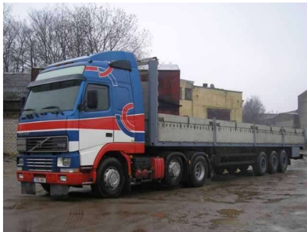
Joonis 6. Lahtine madelpoolhaagis (PULMAN) [19]
