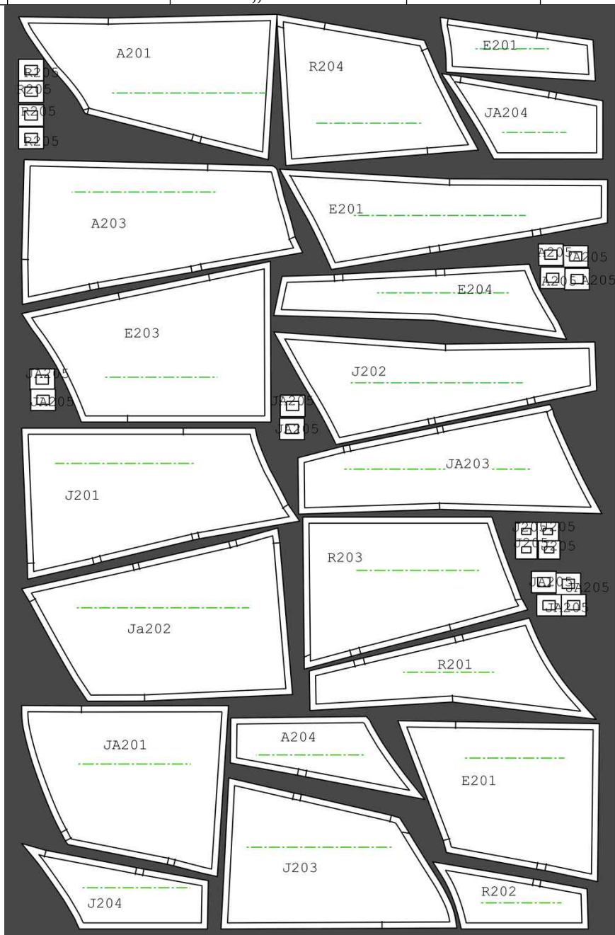
Joonis 27. Halli põhikanga kombineeritud paigutusjoonis M1:8
