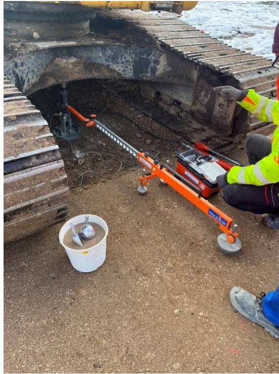
Foto 3. Plaatkoormuskatse esimene mõõtmine [21]
