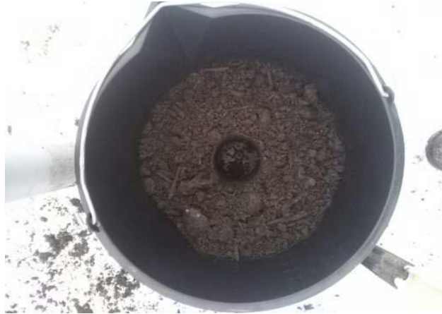
Joonis 12. Ämbrisse kogutud proovide segust on toruga võetud massvähendatud proov
