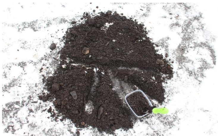
Joonis 13. Vahelduva kühveldamise ja sektoriteks jaotamise põhimõte
