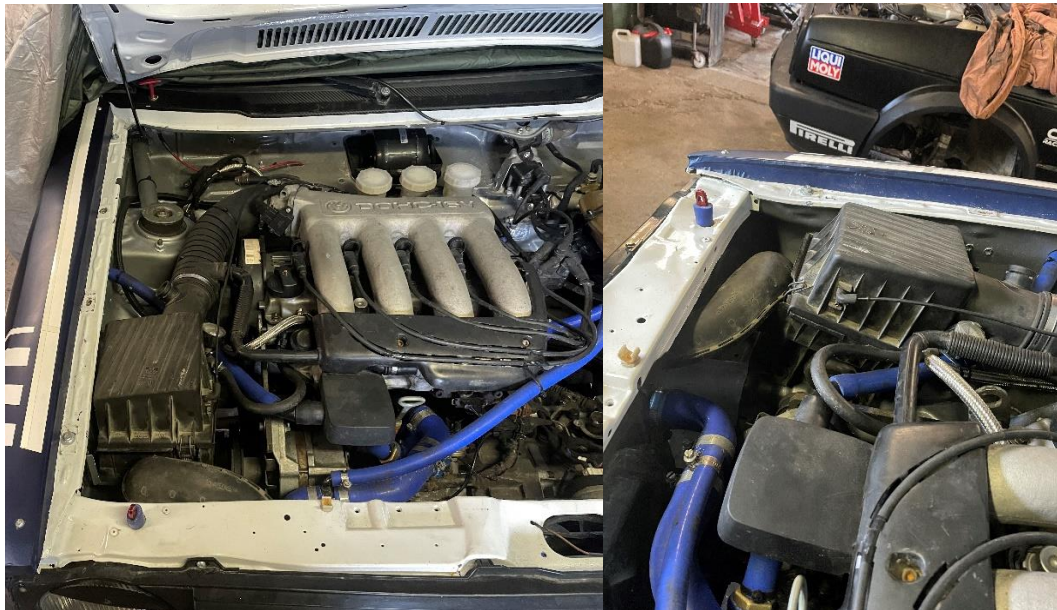
Sele 15. Originaalse filtrikorpusse paigutus mootori ruumis
