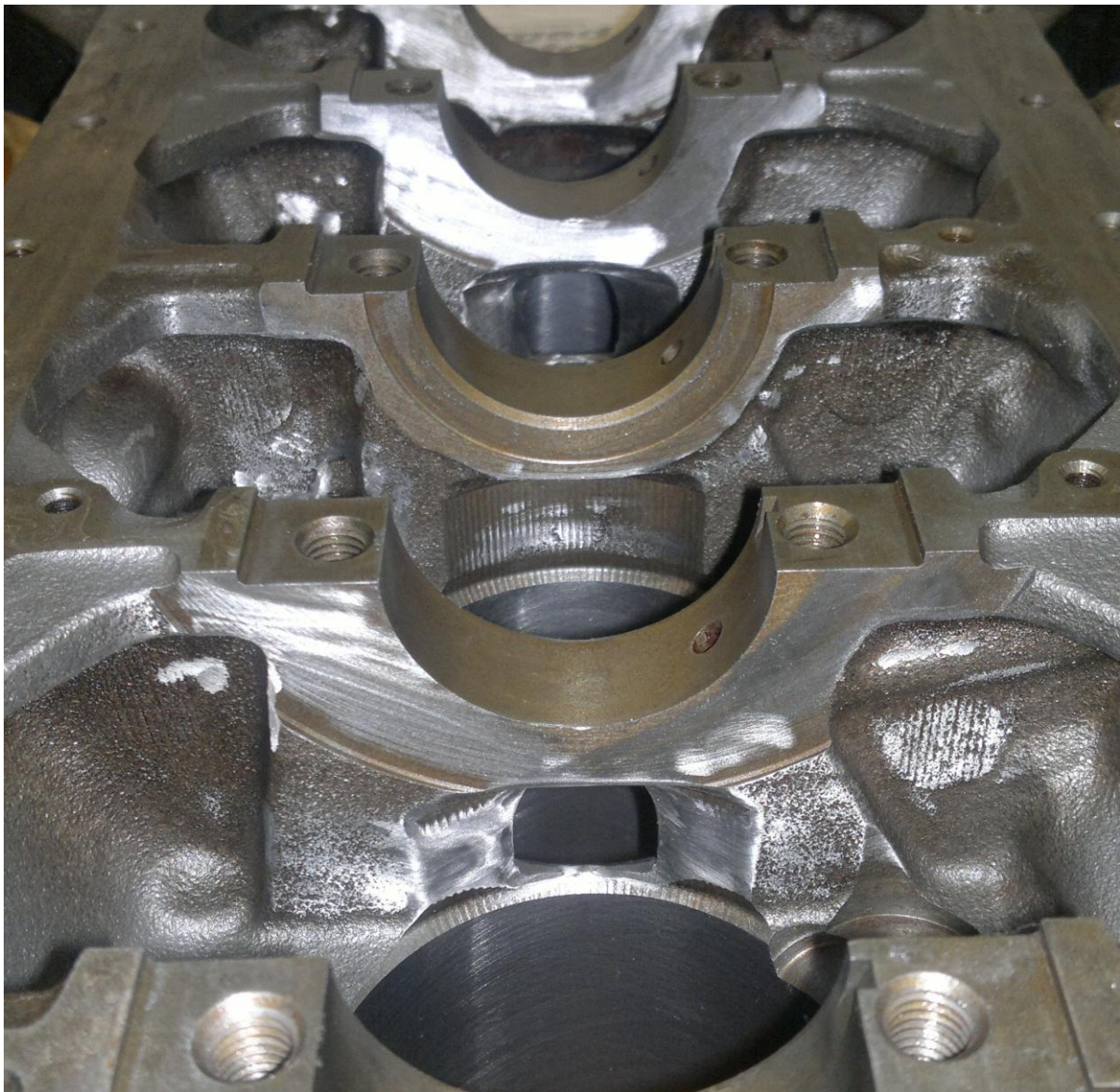
Sele 4.2.1 Kanalid silindrialuste ruumide ühendamiseks [24]
