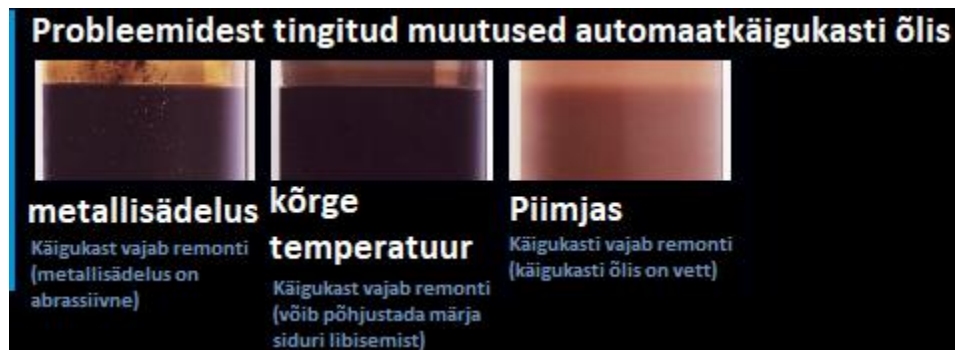
Sele 8. Probleemidest tingitud muutused automaatkäigukasti õlis [12]
