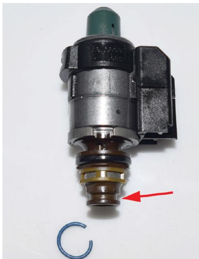
Sele 13. 722.9 solenoid, millel O-rõngas murdunud
