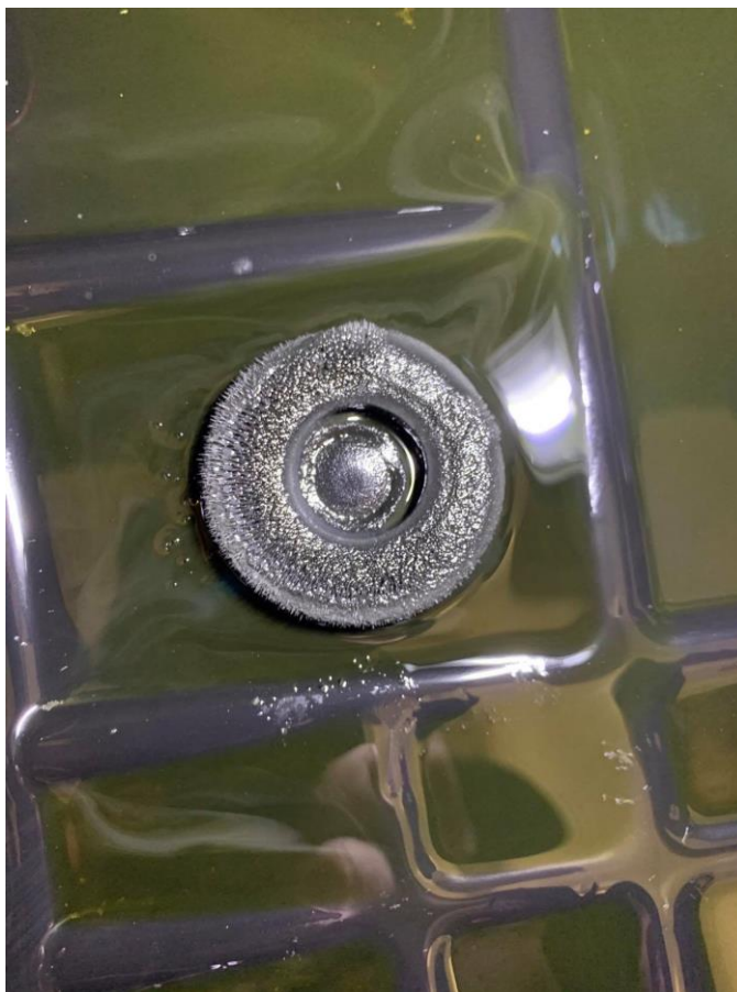
Sele 11. TR690 põhjavannil kulumisest tingitud metallitolm magnetil
