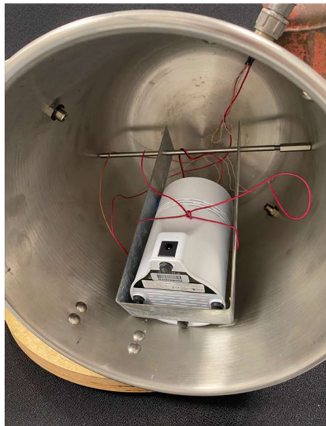
Foto 7. Radon Eye Plus2 mõõteseadme koos selle lehtmetailist valmistatud hoidikuga
