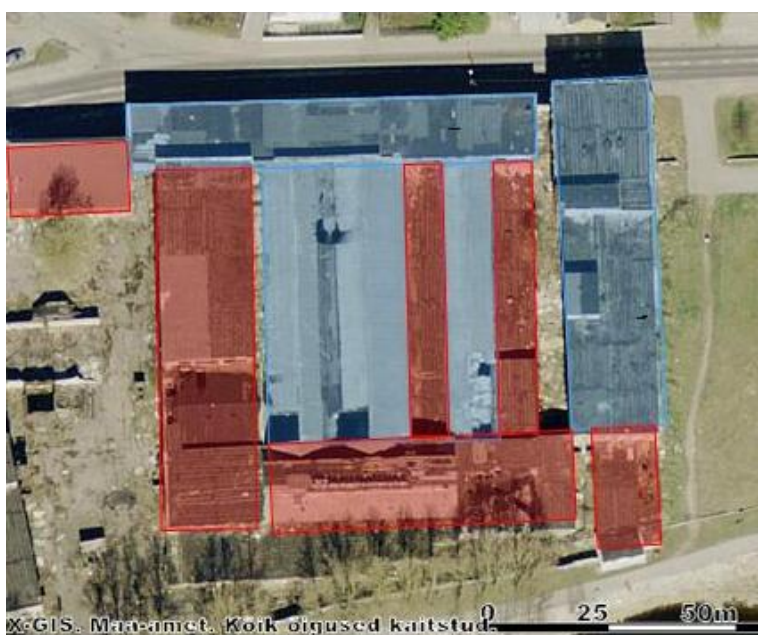
Joonis 6. Situatsiooniskeem 1:1000, olemasolev olukord [1]; sinisega on toodud säilitatavad osad, punasega lammutatavad osad
