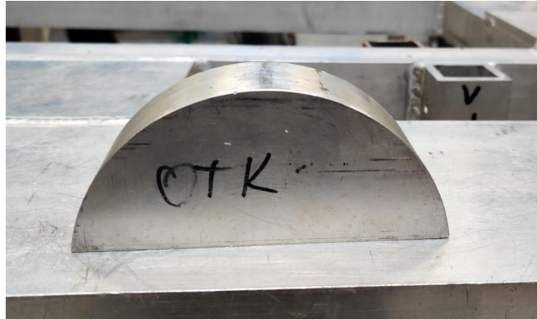
Sele 7. Raami toetamiseks kasutatud klots
