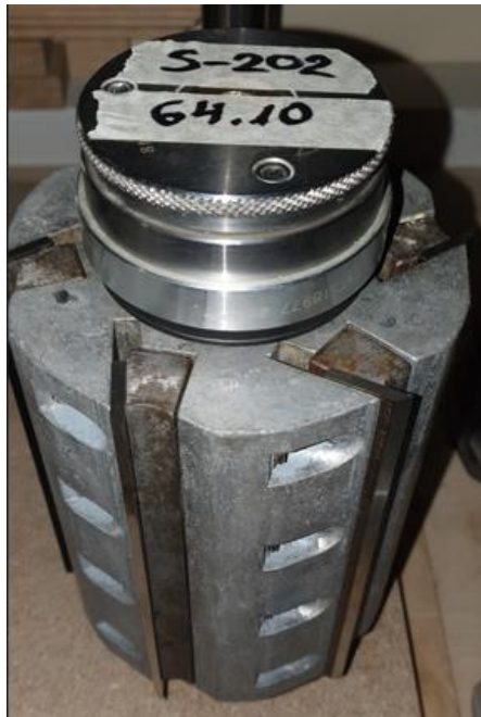
Joonis 14. Hõõvelduspingi markeeritud lõikuripea [koostatud autori poolt]
