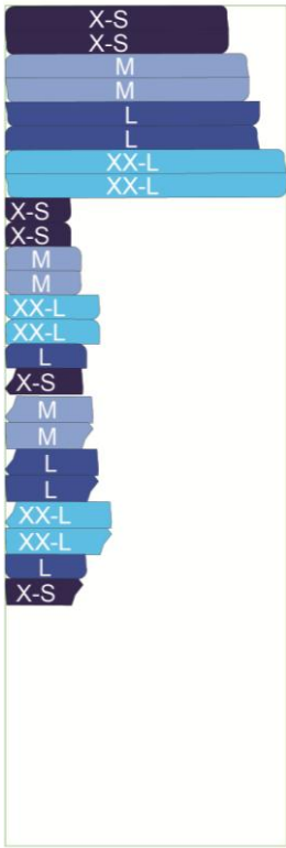
Joonis 39. Mudeli Loki ripstop kanga paigutusjoonis mõõtkava 1:13
