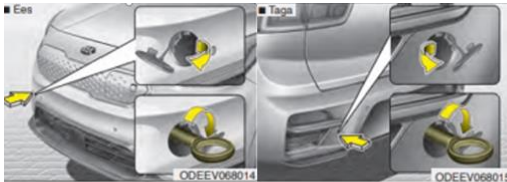
Joonis 9. Elektriauto veoaasa asukoht ees ja taga [23].
