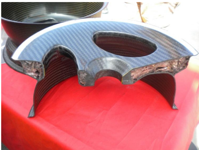
Sele 10. Üheosaline süsinikkiudest valmistatud velg
