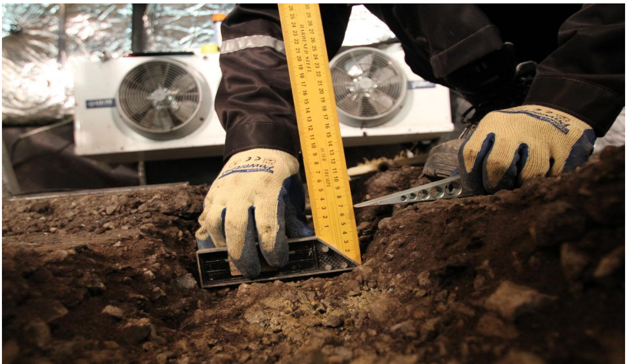
Foto 36. Lammutamisel vajumi mõõtmine mustsegust kattel [1]
