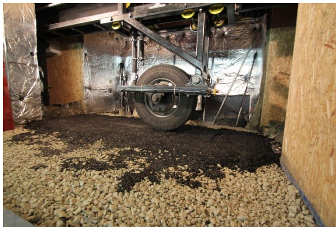
Foto 3. Konstruktsiooni koormav ratas [1]
