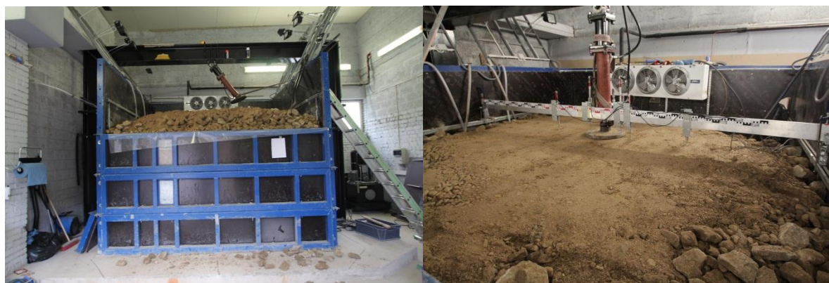
Foto 1 ja 2. Metallkast ja dünaamiline koormusplaat [1]
