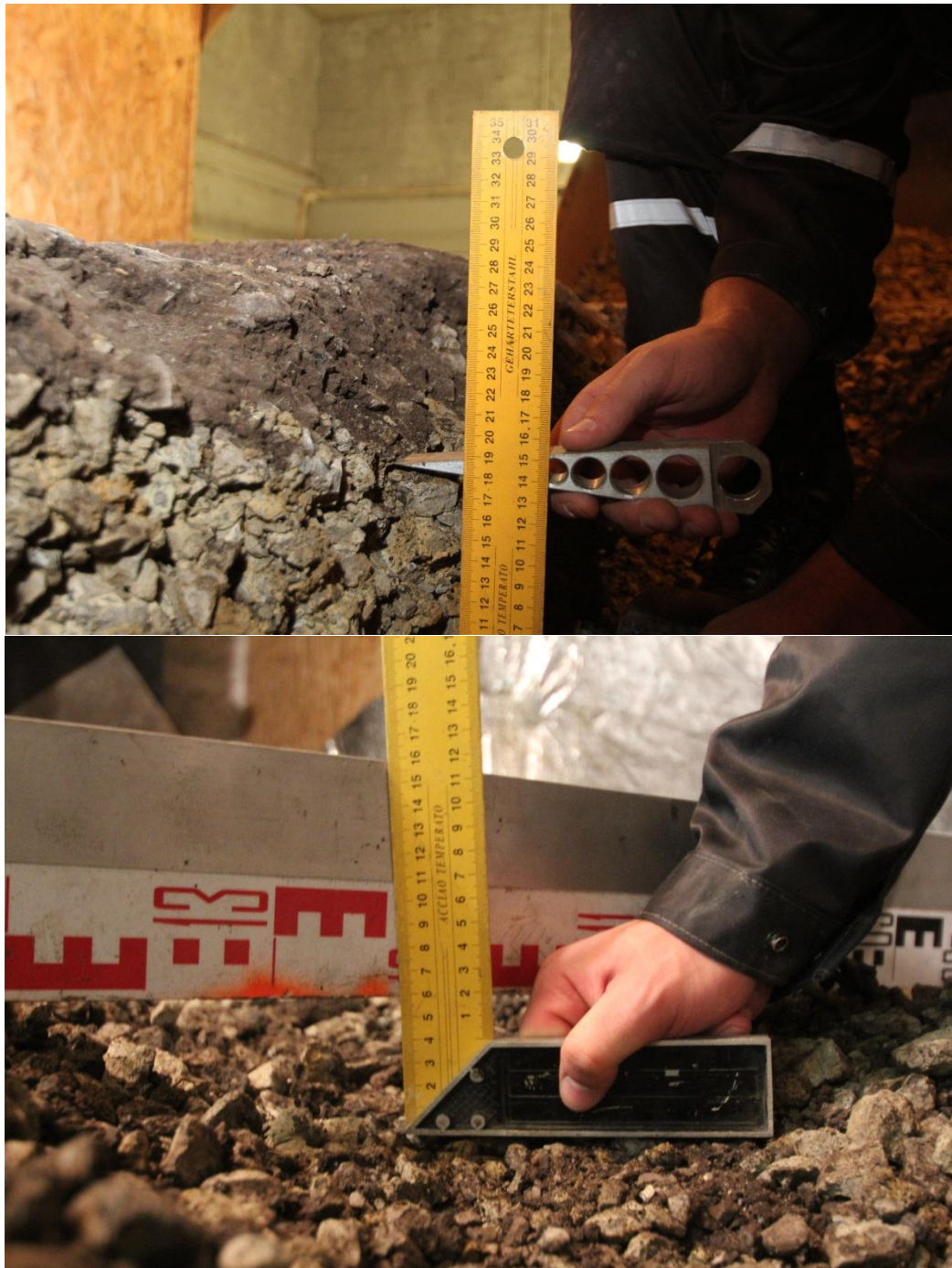
Foto 37 ja 38. Vajumi mõõtmine killustikaluses [1]
