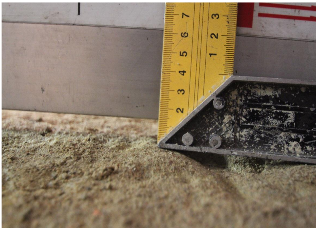
Foto 40. Vajumi mõõtmine drenkihil [1]
