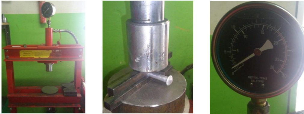
Joonis 18. Alumiiniumneedi pressimine
