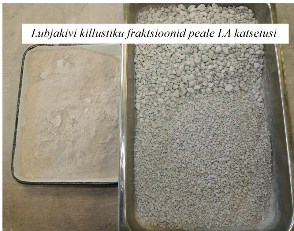
Joonis 17. Killustiku purunemiskindluse määramine Los Angelese katsel [8]
