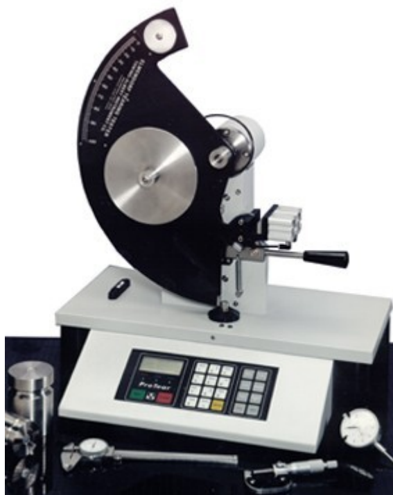
Foto 6. Elmendorf tester rebimistugevuse määramiseks [38]
