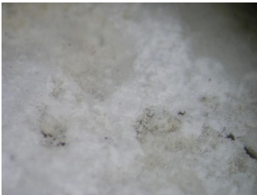
Foto 11. Valgusmikroskoobiga tehtud pilt prao välispinnale sadestunud kristallist
