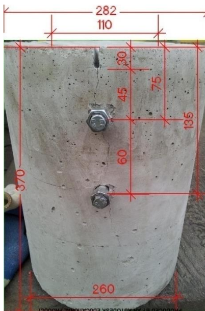
Foto 8. Katsekeha tekitatud pragude ja mõõtudega
